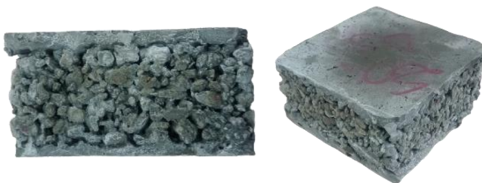
Figura 13 - Corpo de prova capeado com pasta de cimento
