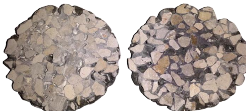
Figura 6 - Amostra transversal de concreto permeável com excesso do volume de pasta de cimento
