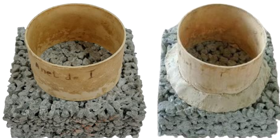
Figura 14 - Anel de infiltração de 100 mm (a) e com a base vadada (b)
