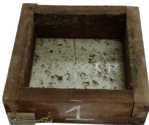
Figura 12 - Moldes dos corpos de provas
