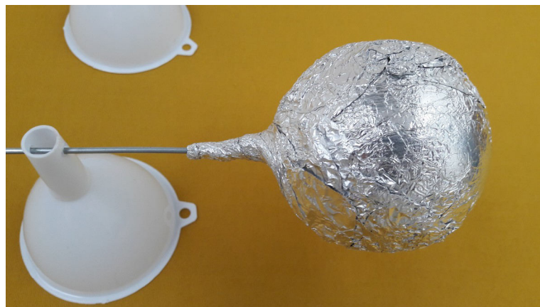
b) detalhe da esfera de isopor envolvida por filme de alumínio
