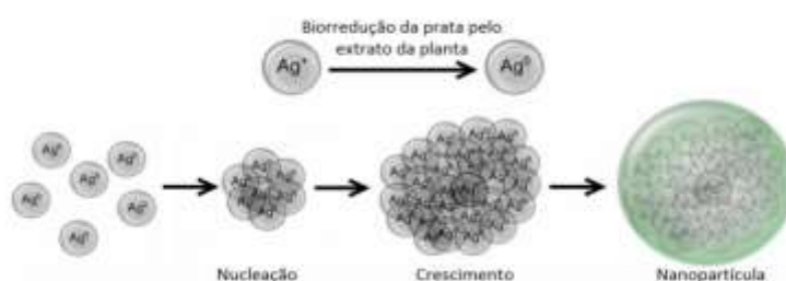
Figura 5 – Esquema do mecanismo generalizado de 3 passos para a formação de nanopartículas metálicas por síntese verde
