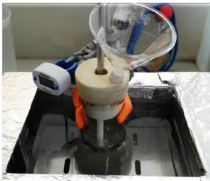
Figura 18: Sistema experimental utilizado para o processo de hidrólise ácida [73].
