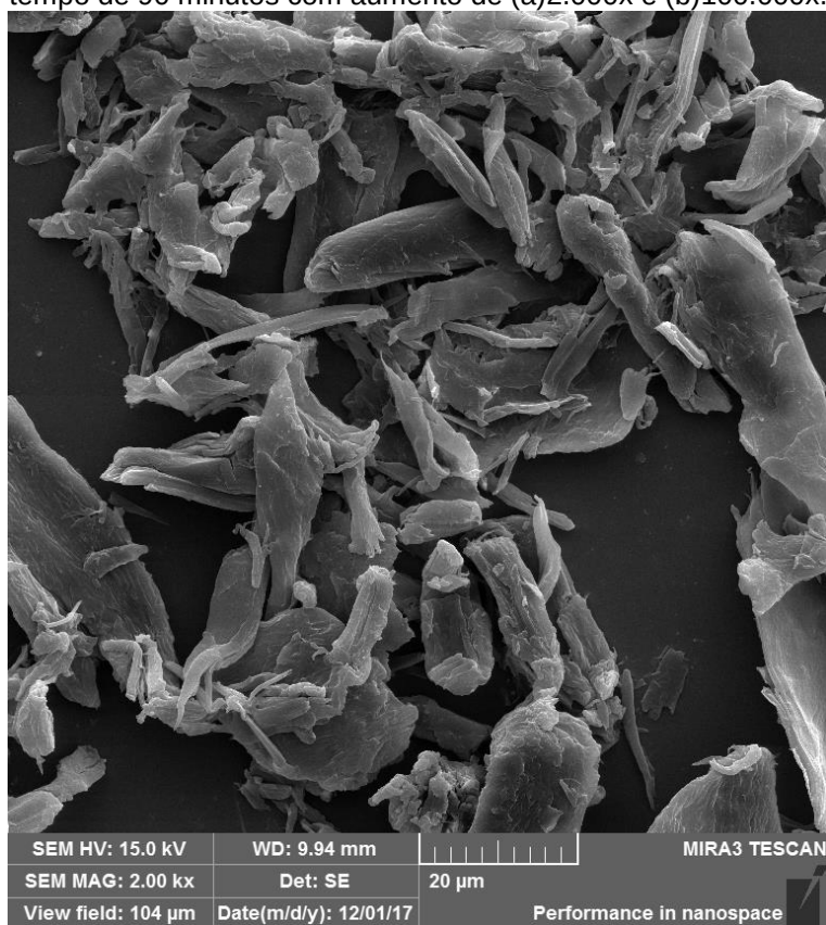
Figura 38: Imagem de microscopia eletrônica de varredura da CMC hidrolisada com tempo de 90 minutos com aumento de (a)2.000x e (b)100.000x.
