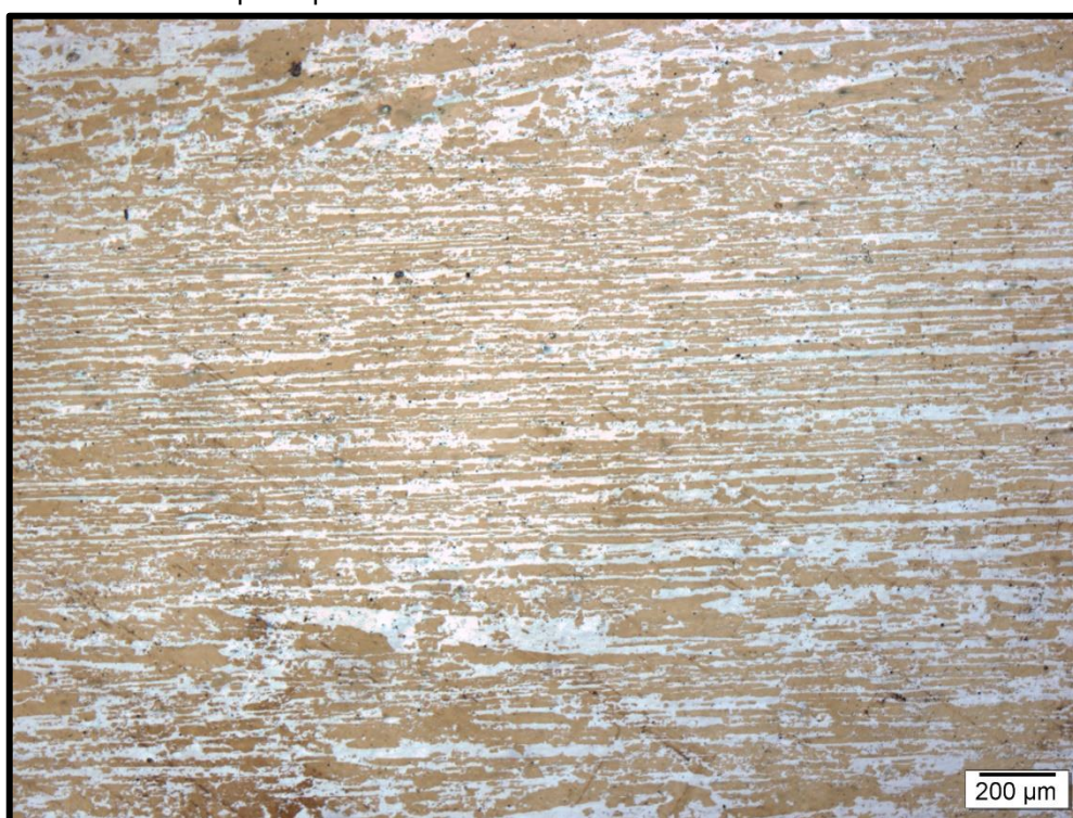
Figura 31 - Micrografia da face superior da chapa do UNS S32750 como recebido, amostra atacada por aquecimento com chama incidente.
