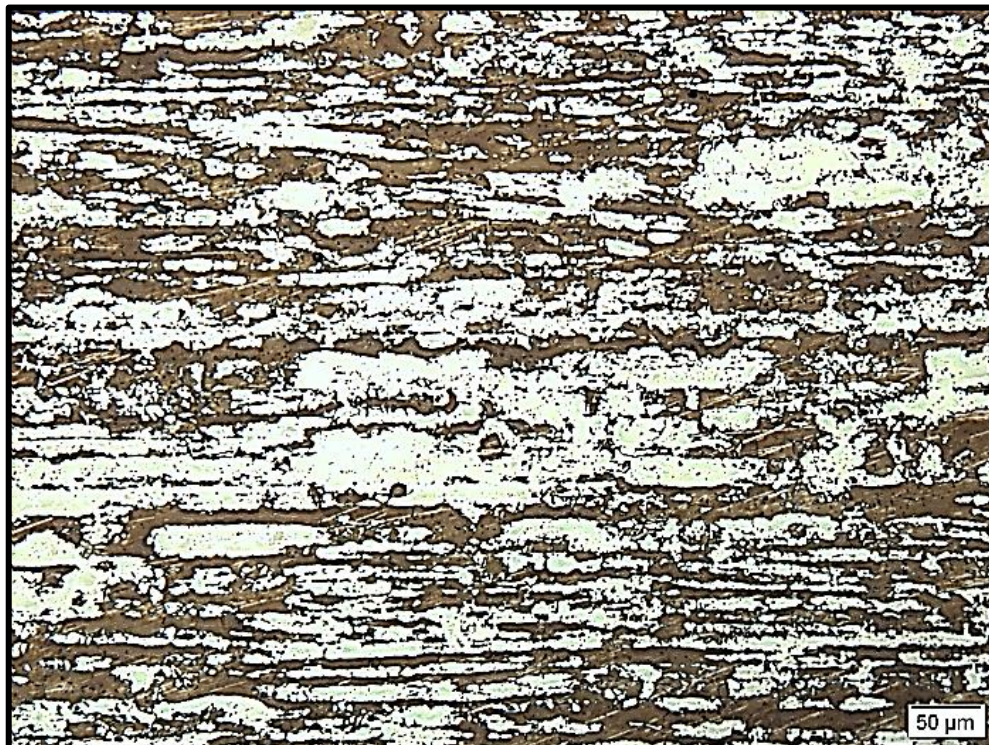
Figura 29 - Micrografia da face superior da chapa do UNS S32750 como recebido, amostra atacada com o reagente Beraha II modificado.
