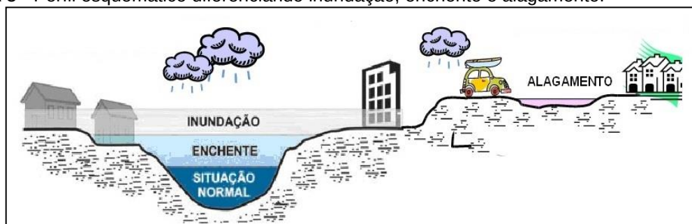
FIGURA 3 - Perfil esquemático diferenciando inundação, enchente e alagamento.
