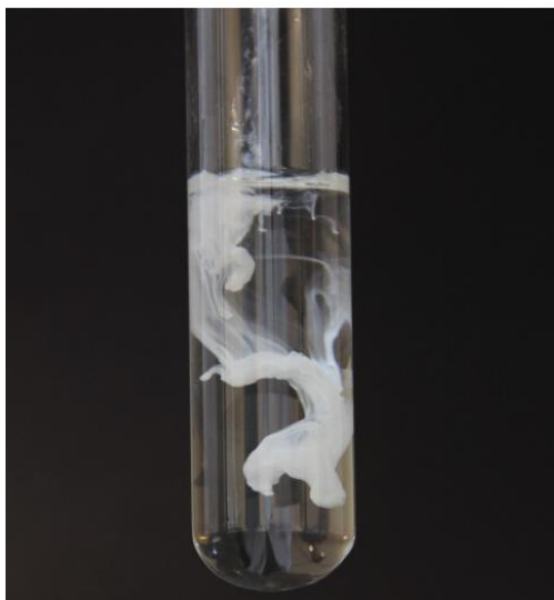
Figura 10: Formação do cloreto de prata durante o teste de verificação de íons cloreto
