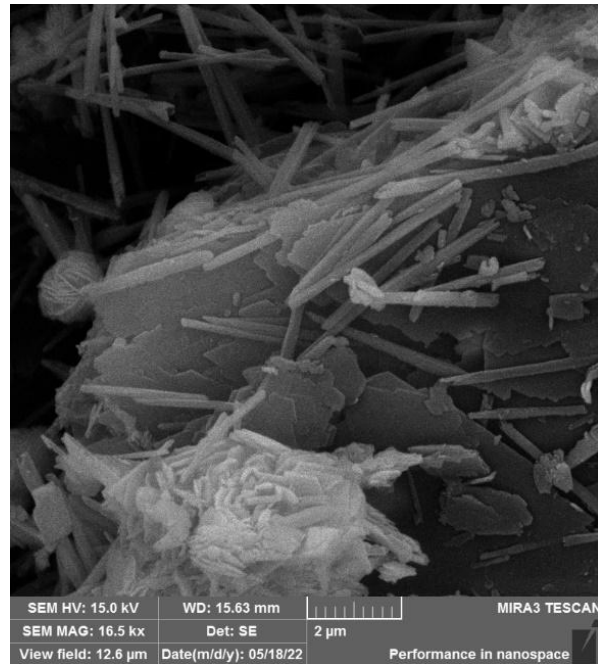
Figura 40 Ampliação da amostra TFSA V2 0-3. O resultado mostra concentração de estruturas tipo bastão bem como estruturas tio-flor, localizada no lado direito da figura.
