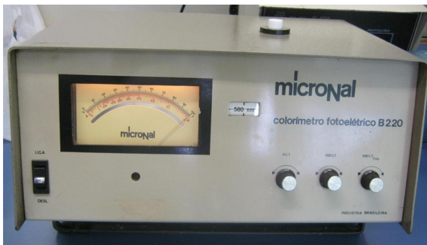
Figura 4 – Espectrofotômetro calibrado em 580 nm para ajustar a turvação do inóculo.
