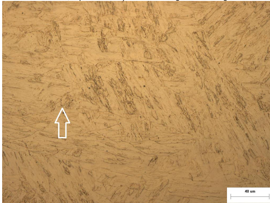
Figura 76 – Microestrutura da amostra 5x47x94mm, com destaque para a austenita com morfologia de Widmanstätten, representada pela seta. Reagente metalográfico Vilella.
