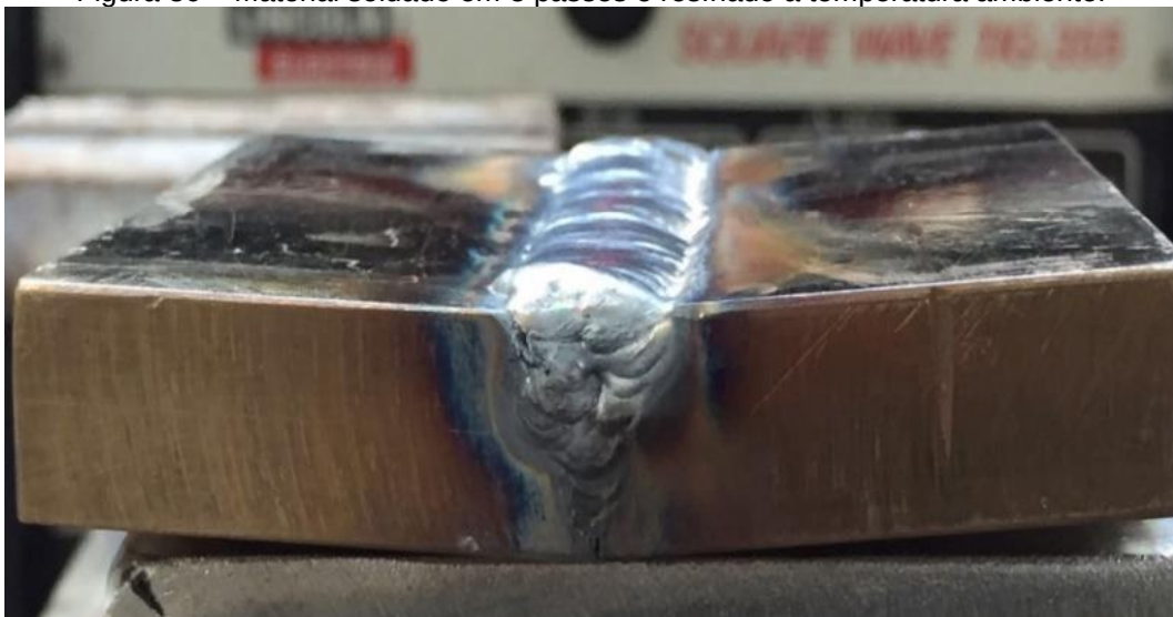
Figura 36 – Material soldado em 8 passes e resfriado a temperatura ambiente.
