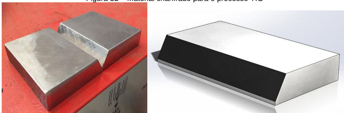
Figura 32 – Material chanfrado para o processo TIG
