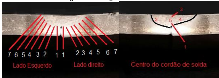
Figura 41 – Regiões da amostra divididas para análise microestrutural da amostra 15X47X94 mm. Reagente metalográfico Beraha B4.
