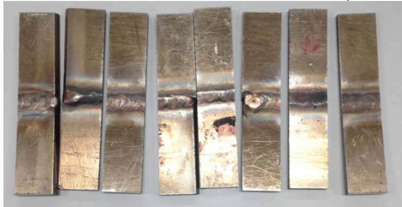
Figura 39 – Material cortado transversalmente ao cordão de solda após soldagem TIG
