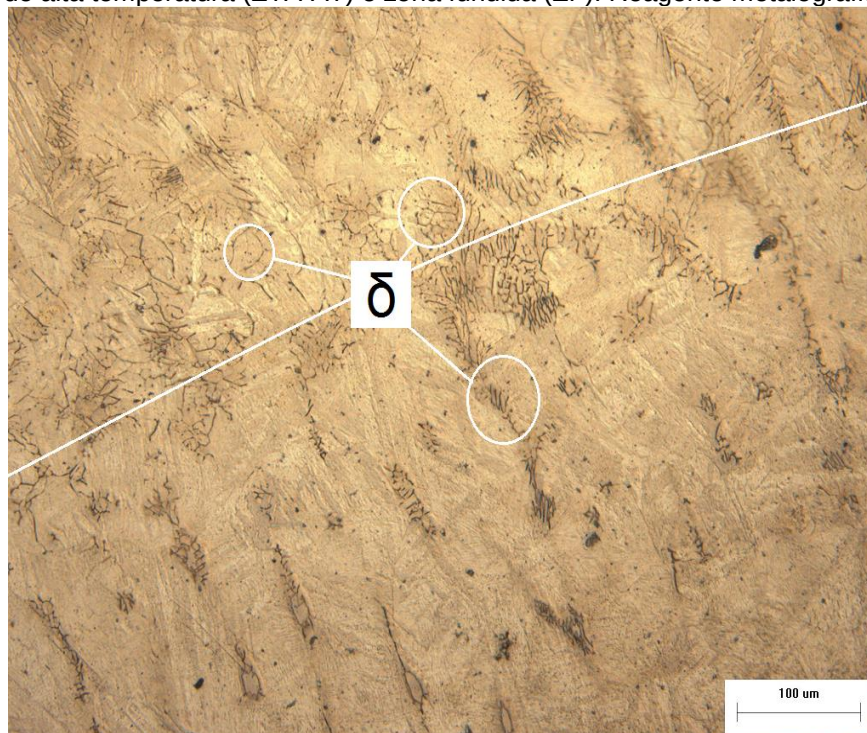
Figura 63 – Microestrutura da amostra 5x47x94mm. Região de transição da zona termicamente afetada de alta temperatura (ZTA-AT) e zona fundida (ZF). Reagente metalográfico Vilella.
