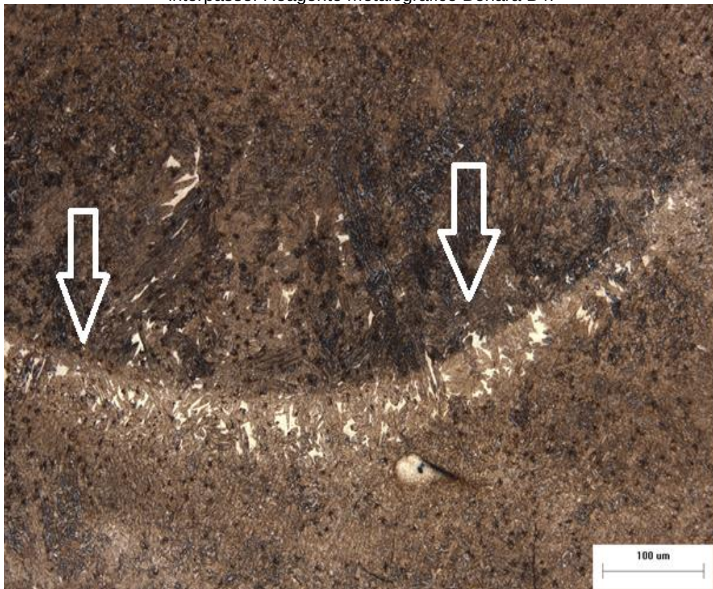
Figura 71– Microestrutura da amostra 15x47x94mm com destaque para a ferrita delta na região interpasse. Reagente metalográfico Behara B4.
