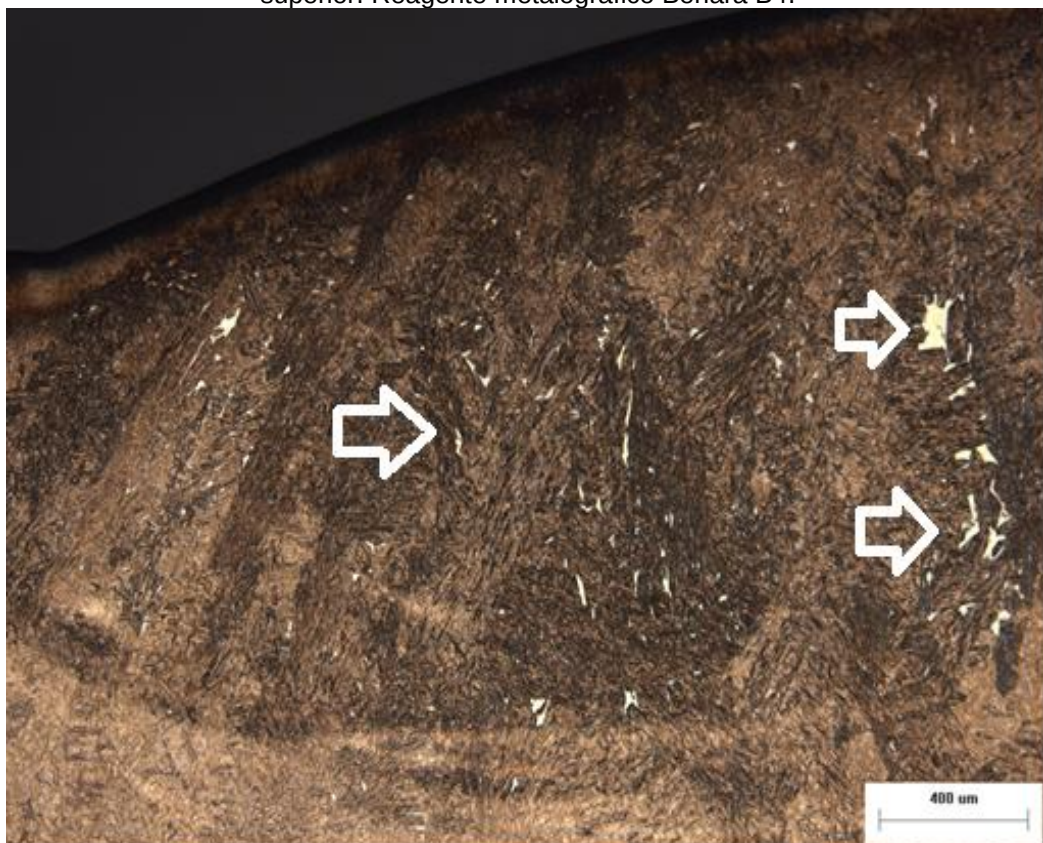
Figura 70– Microestrutura da amostra 15x47x94mm com destaque para a ferrita delta no cordão superior. Reagente metalográfico Behara B4.
