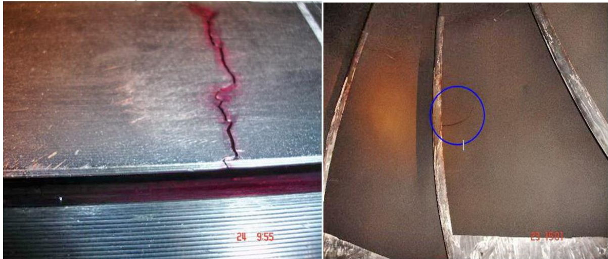
Figura 1 – Turbina danificada da Usina Hidrelétrica de ITAIPÚ
