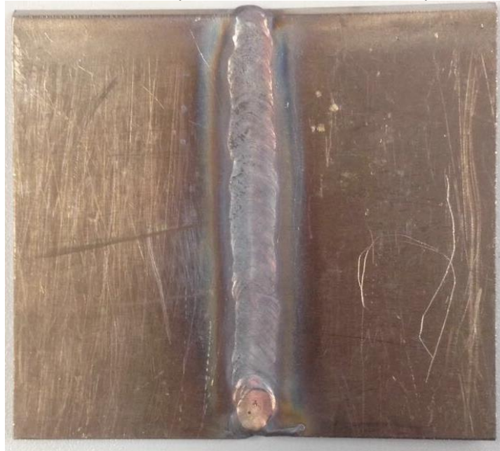
Figura 33 – Material soldado passe único e resfriado a temperatura ambiente
