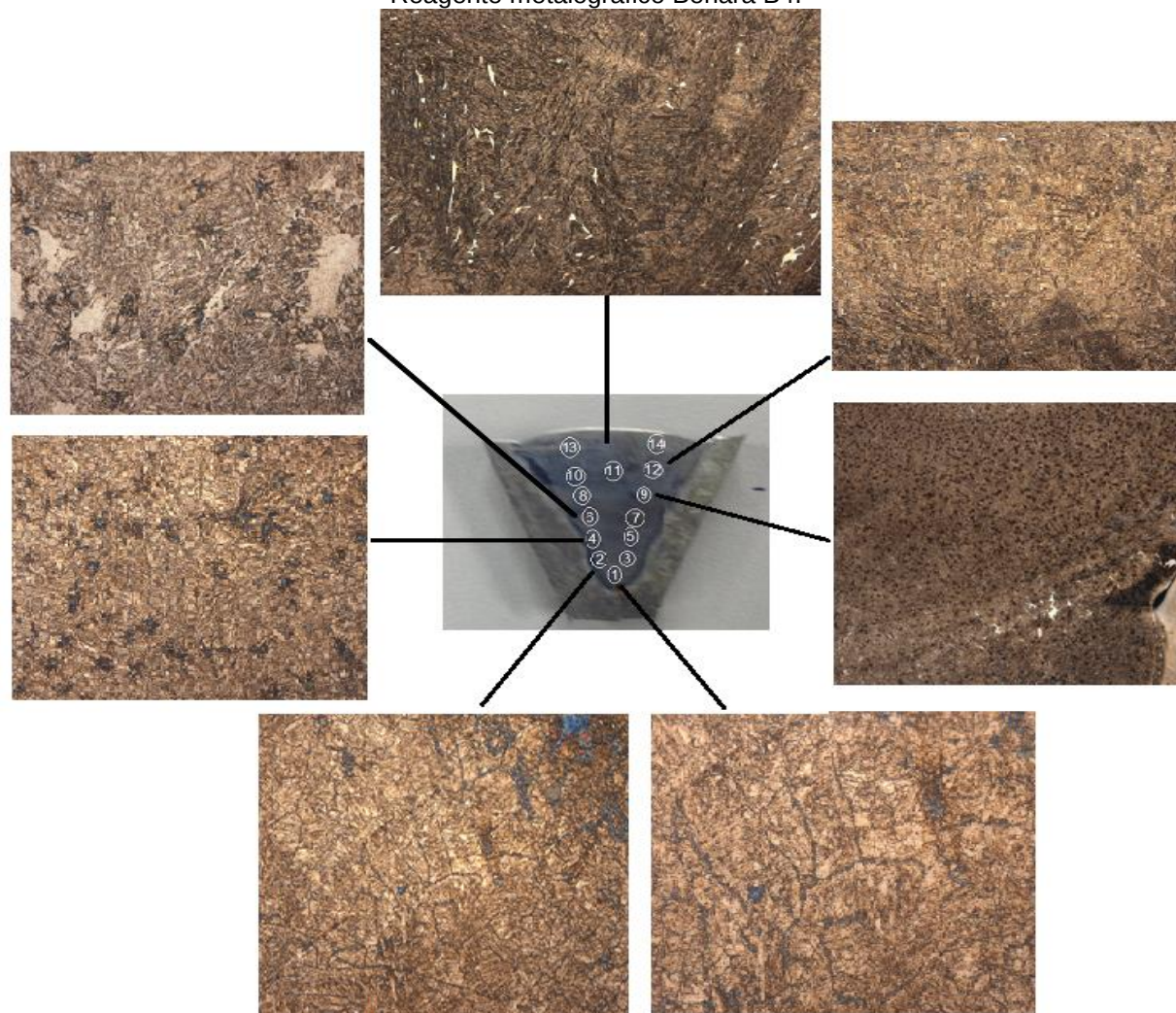
Figura 73– Microestrutura da amostra 15x47x94mm com destaque para o refino de granulação entre a região intermediária e superior da solda multipasse. Reagente metalográfico Behara B4.
