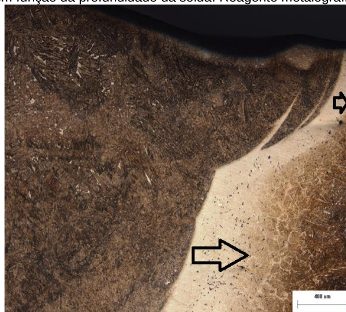
Figura 61 – Microestrutura da amostra 15x47x97. Região da solda, mostrando a diferença de largura da ZTA-AT em função da profundidade da solda. Reagente metalográfico Beraha B4.
