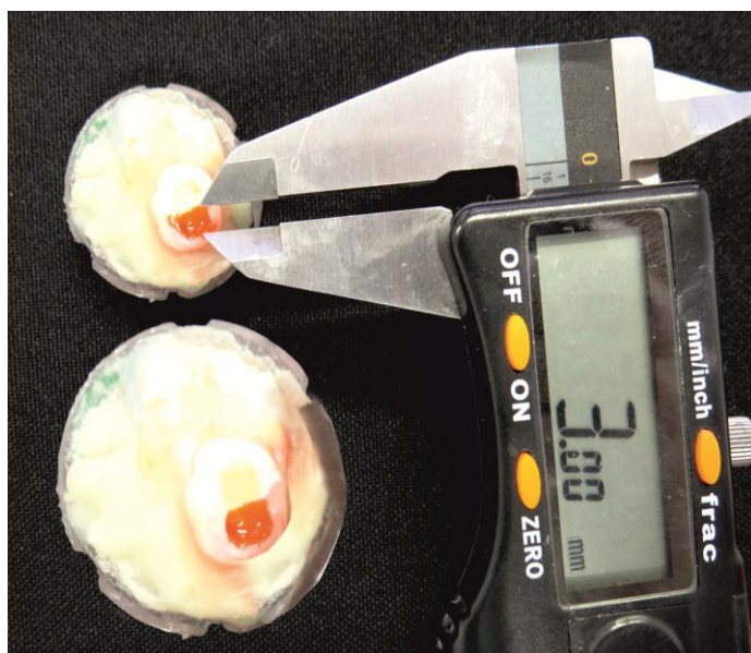
Figura 5 - Paquímetro medindo a camada de esmalte de unha aplicada na metade do assoalho cavitário
