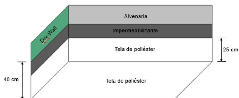
Figura 04– Colocação de tela de poliéster.
