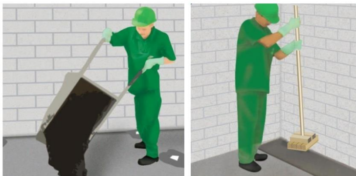
Figura 05 – Execução das mestras.
