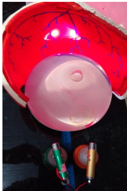
Figura 4.24 Feixe de luz divergente que simula a incidências de raios luminosos de um objeto próximo a vista. Fonte: O autor.
