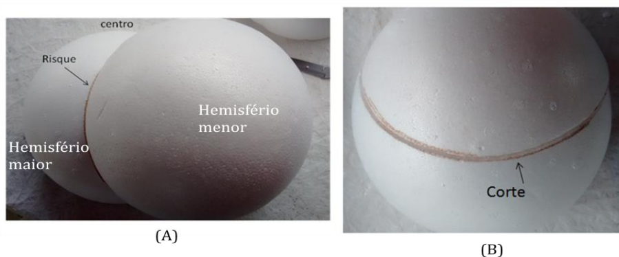
Figura 5.3 Risque a bola maior usando como base o contorno da bola menor e a corte. [Trierveiler, 2016]
