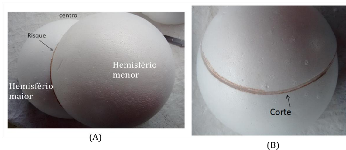
Figura 4.2 (A) Sobreposição das semiesferas. É importante que superfície externa da semiesfera menor esteja apoiada tanto na superfície de apoio como no centro da semiesfera maior. (B) corte feito com uma faca ou estilete. Fonte: O autor.
