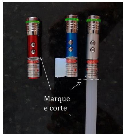
Figura 4.6 Como o corpo da caneta é feita de alumínio, podemos cortá-lo sem maiores dificuldades. Fonte: O autor.
