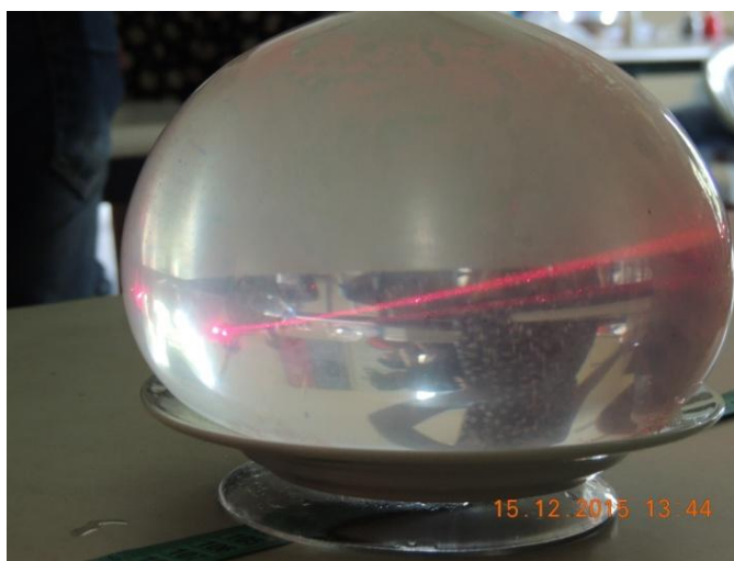
Figura 5.19 A lente flexível produzida pelos alunos. O feixe de luz paralelo sofrendo refração. Fonte: O autor.
