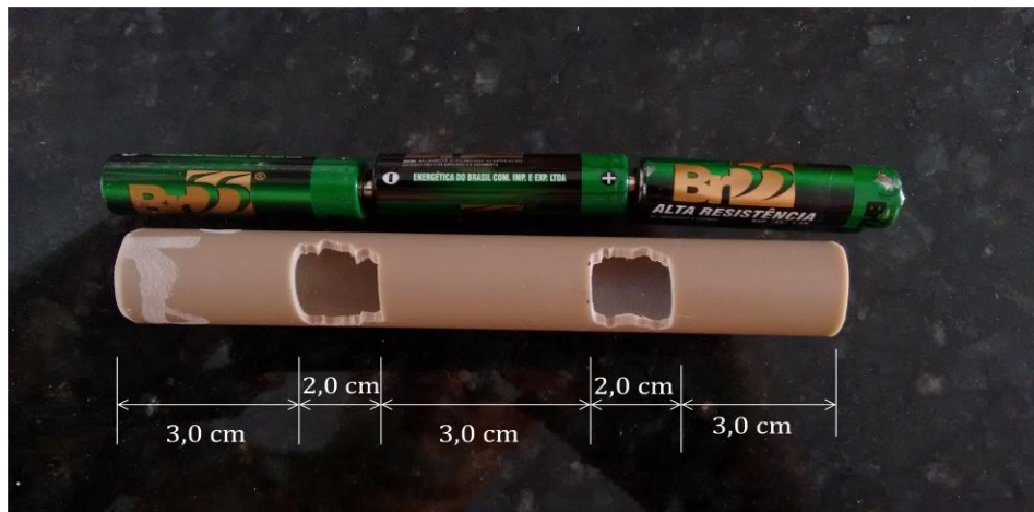
Figura 4.9 Podemos abrir as fendas usando outras ferramentas, como serra mármore elétrica, desde que se tome todos os cuidados e que se use equipamentos de proteção individual, como óculos. Fonte: O autor.
