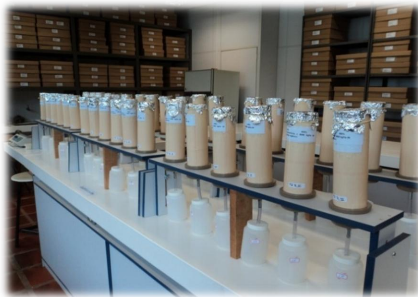
Figura 2.1. Disposição do experimento para avaliação da percolação de nitrato. Tubos de PVC contendo amostras de solo não revolvido ou revolvido com adição ou não de ROI em experimento de análise de percolação de \text{N-NO}_3^- .
