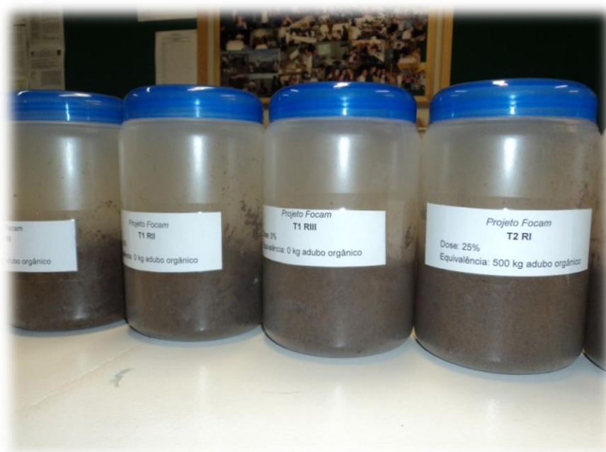
Figura 2.3. Frascos de polipropileno contendo solo peneirado com adição ou não de resíduo de abatedouro utilizado no experimento para avaliação da mineralização de \text{N-NO}_3^- .
