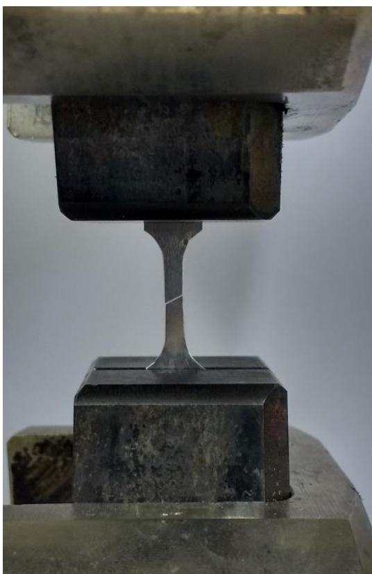
Figura 4.14 – Corpo de prova de Al após o ensaio de tração.
