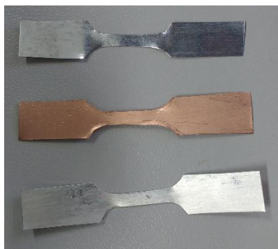
Figura 3.8 – Corpos de prova de Al, Cu e Ag, respectivamente, após laminação e corte.
