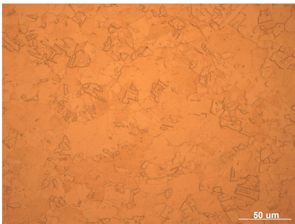
Figura 3.2 – Metalografia do cobre em seu estado inicial.
