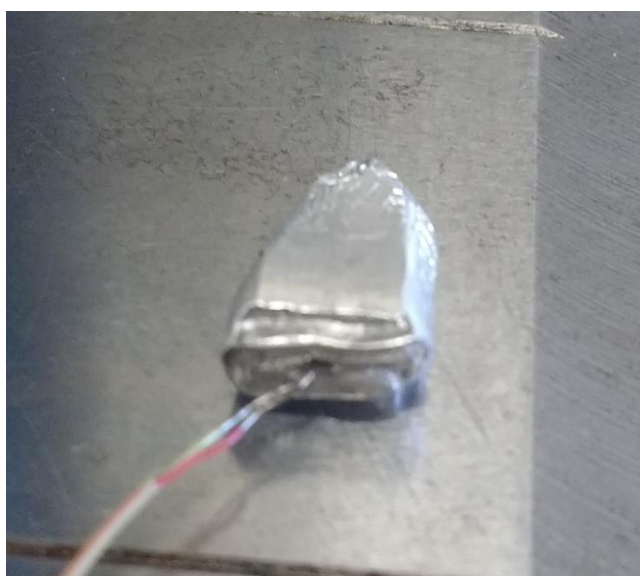
Figura 3.4 – Localização do furo para inserção do termopar nas amostras.
