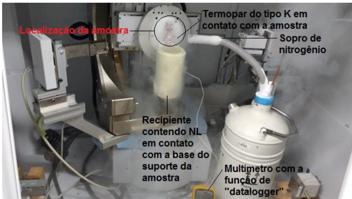
Figura 3.6 – Aparato experimental para realização de difração de raios-X a temperaturas criogênicas no aparelho PANanalytical X'Pert PRO.
