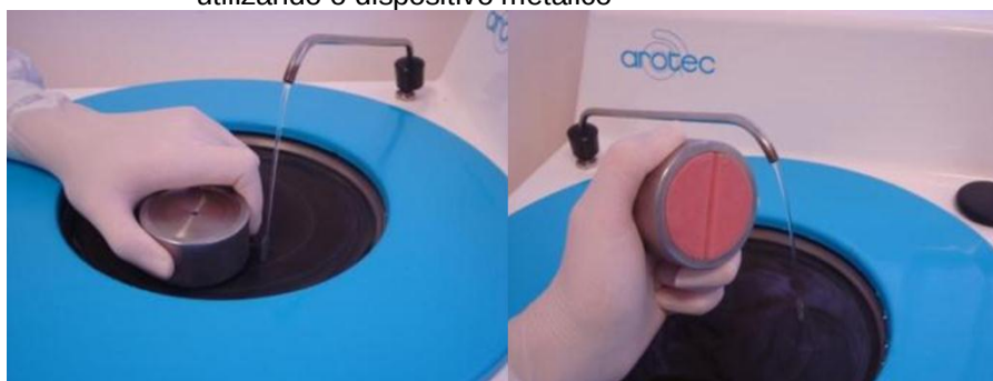
FIGURA 4 – Polimento do corpo de prova da análise de grau de conversão utilizando o dispositivo metálico
