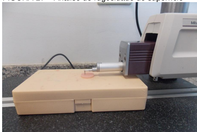
FIGURA 27 – Análise de rugosidade de superfície
