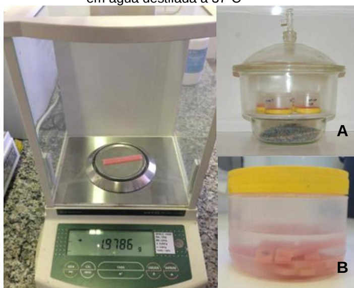
FIGURA 23 – Pesagem do espécime seco e úmido em duas etapas: A – 1ª etapa: após armazenamento em dessecador; B – 2ª etapa: após imersão em água destilada a 37°C
