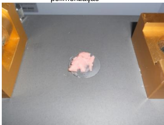
FIGURA 7 - Resina acrílica posicionada sobre a superfície do cristal ATR para as análises de cinética de polimerização
