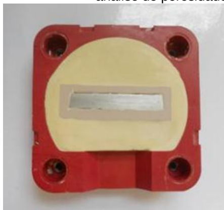
FIGURA 21 - Inclusão do conjunto molde/matriz em mufla plástica para a análise de porosidade
