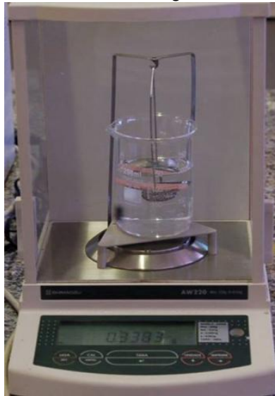
FIGURA 24 – Pesagem adicional com o espécime totalmente imerso em água destilada
