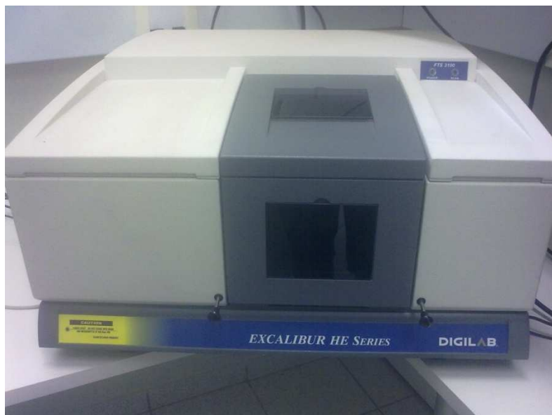
Figura 14 – Espectrofotômetro utilizado para medidas de absorção na região do infravermelho dos pós dos sistemas \text{KSr}_2\text{Nb}_5\text{O}_{15} e \text{KSr}_2\text{Nb}_5\text{O}_{15} (Fe, Ni, Co).
