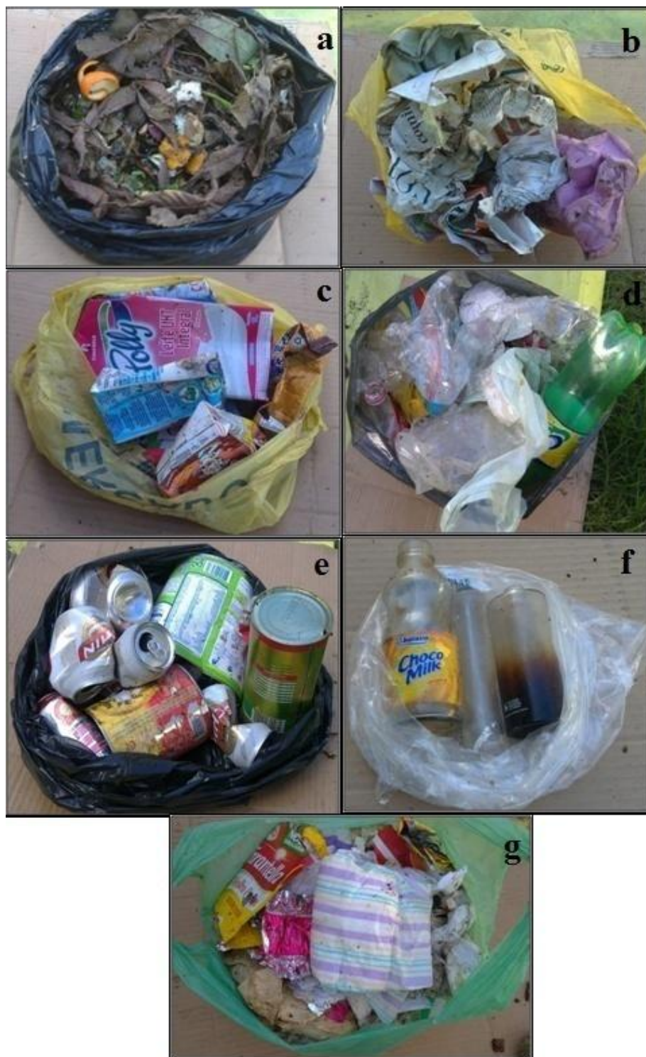
Figura 8 - Componentes encontrados nos RSD da coleta 2 (a: matéria orgânica, b: papel, c: embalagem cartonada, d: plástico, e: metal, f: vidro, g: rejeitos)
