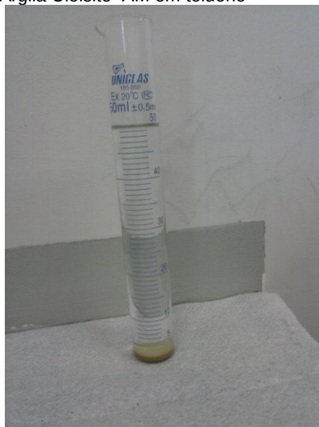
Figura 20 – Inchamento da Argila Cloisite-AM em tolueno
