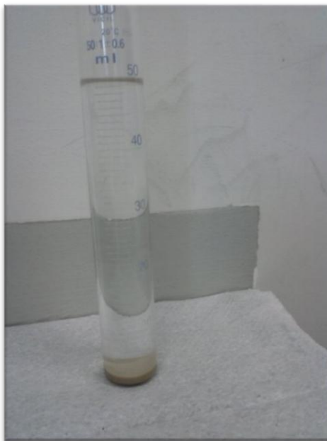
Figura 19 – Inchamento da argila Novaclay em Tolueno
