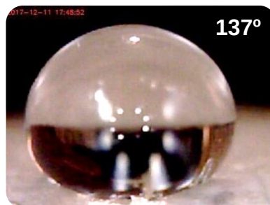
Figura 5.4 – Imagem e ângulo de contato do tecido de algodão recoberto com Fluorobol
