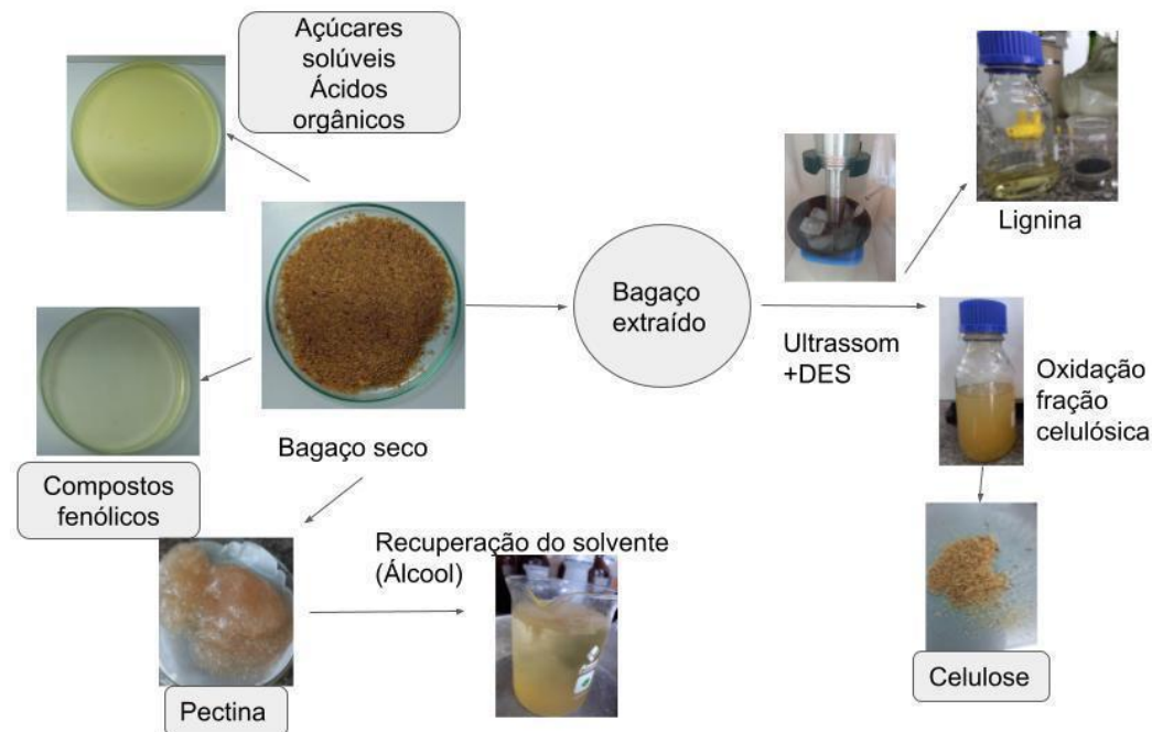
Figura 5. Aproveitamento do bagaço de maçã dentro do conceito de biorrefinaria
