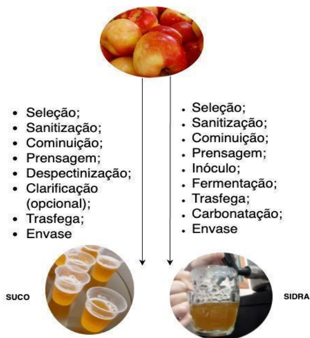
Figura 1. Fluxograma geral de processamento de suco de maçã e sidra
