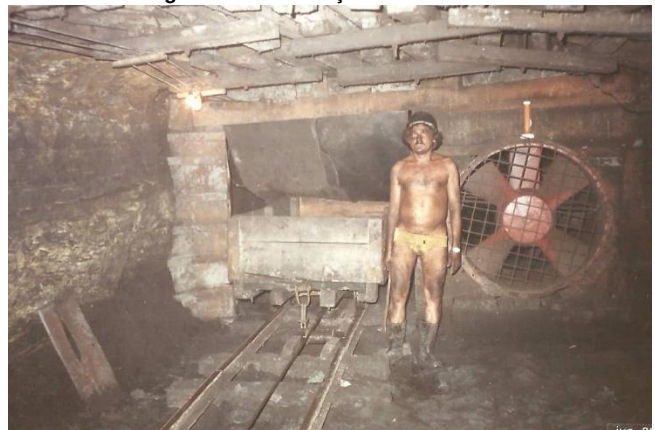
Figura 27 – Ventilação em subsolo
