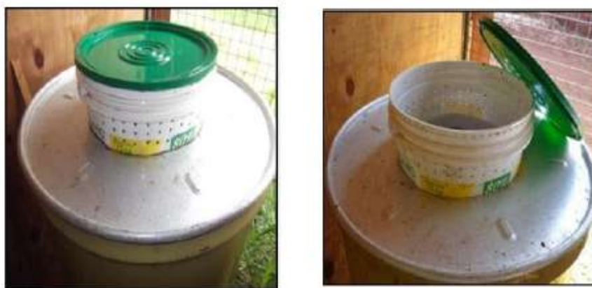
Figura 12 - Tampa de plástico dos reatores facultativos (300 mm de diâmetro e 60 mm de altura) com 120 orifícios de 5 mm.
