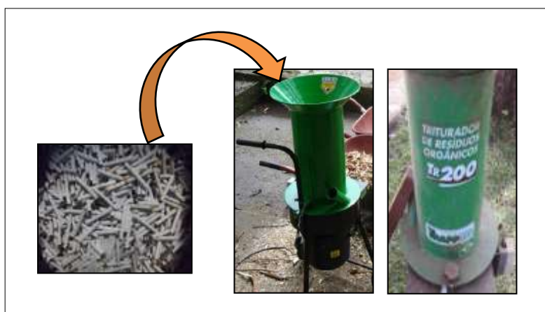
Figura 15 - Triturador orgânico utilizado para a trituração de cigarros contrabandeados.
