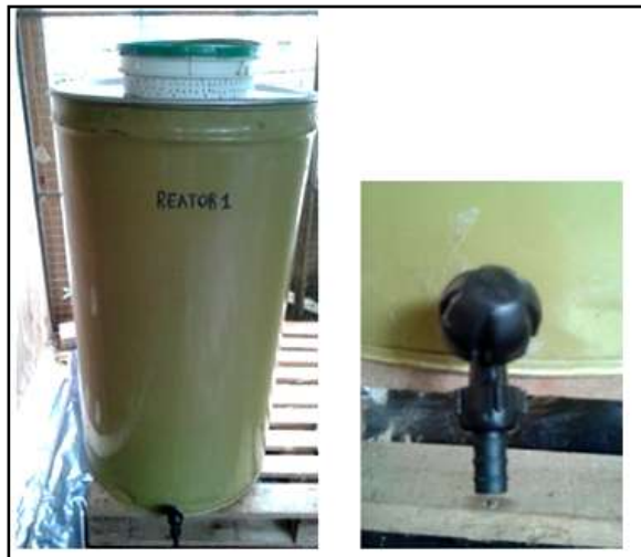
Figura 13 - Modelo de reator facultativo com tampa e orifícios para entrada de ar e torneira acoplada para coleta do chorume.
