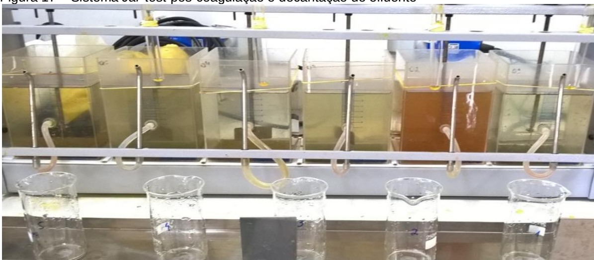
Figura 17 – Sistema Jar-test pós-coagulação e decantação do efluente
