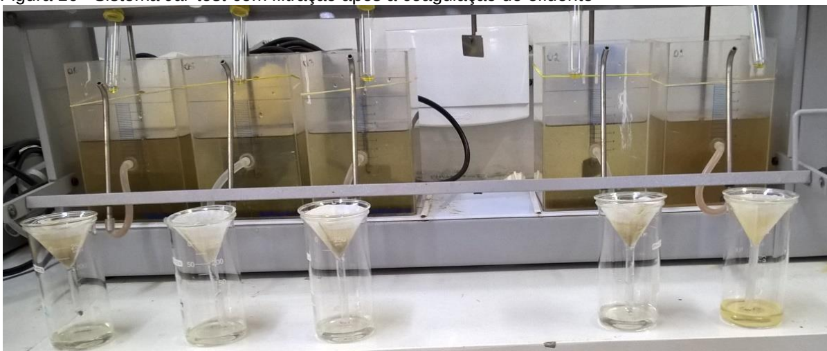
Figura 16 – Sistema Jar-test com filtração após a coagulação do efluente
