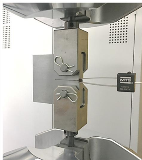
Figura 26: Clip gage no corpo de prova C(T) de propagação de trinca por fadiga.
