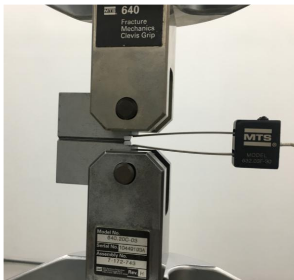
Figura 23: Fixação do clip gage no corpo de prova C(T) de tenacidade à fratura para o ensaio de Integral J.
