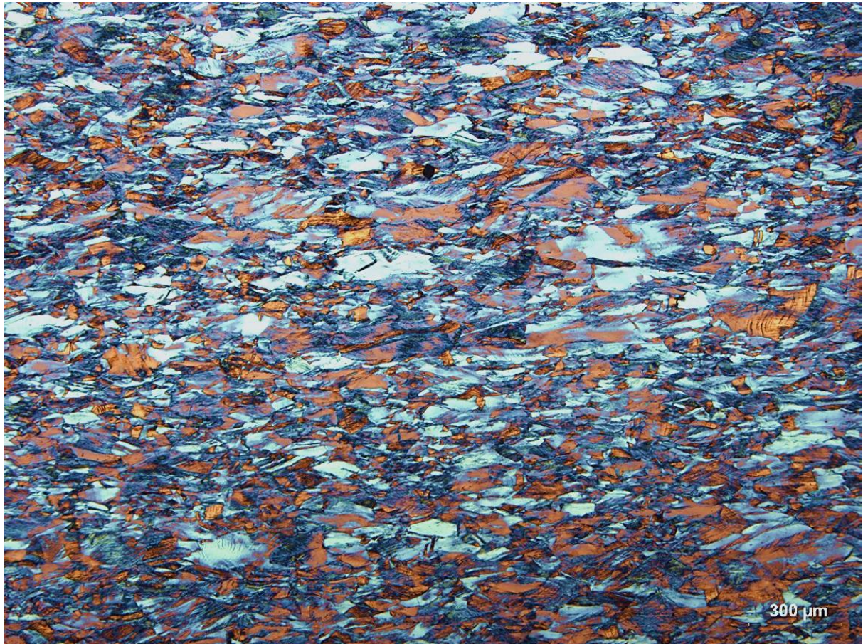
Figura 5.23 – Microscopia óptica da liga Fe18Mn3Al laminada a frio com 50% de redução de espessura atacada com metabissulfito de sódio e apresentando um elevado número de maclas indicados por linhas pretas.
