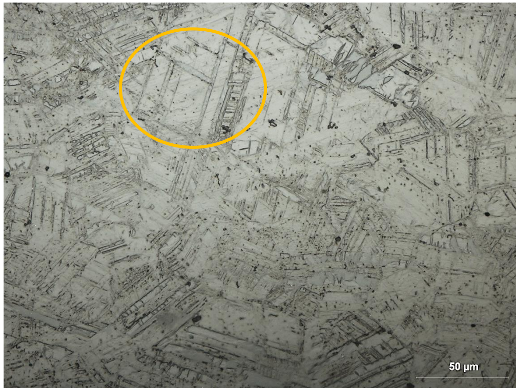
Figura 5.12 – Microscopia óptica da liga Fe18Mn laminada a frio com 20% de redução de espessura, atacada com nital 3% e dentro da elipse amarela pode ser visto uma estrutura característica da martensita \epsilon .
