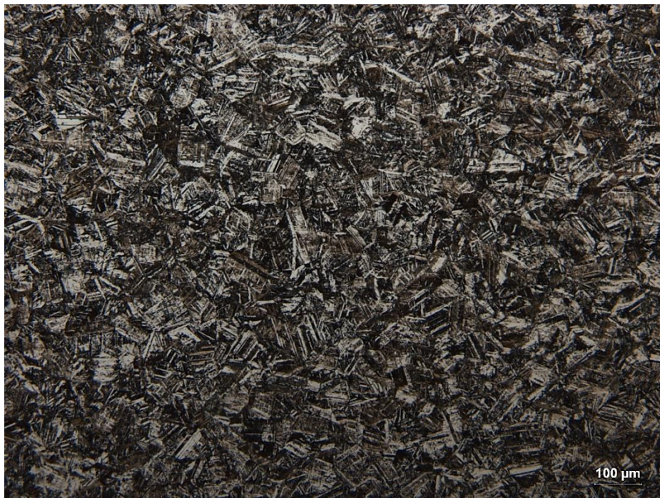
Figura 5.1 – Microscopia óptica da liga Fe18Mn inicial atacada com o reagente de Vilella.
