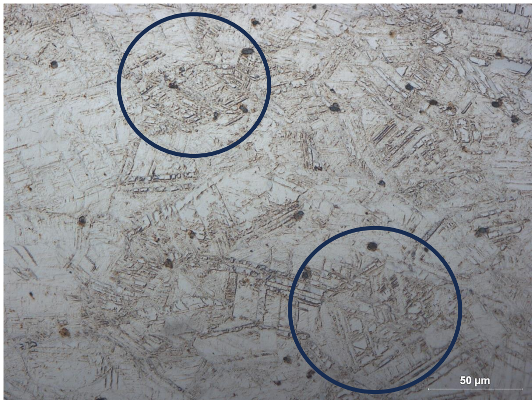
Figura 5.16 – Microscopia óptica da liga Fe18Mn laminada a frio com 30% de redução de espessura e atacada com nital 3%.
