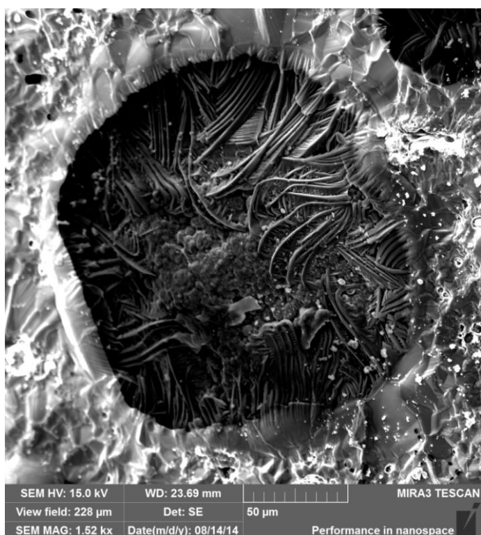
FIGURA 5.50 – MEV de pastilha preparada com \text{Cr}_2\text{O}_3 + Al moído por 2 horas em moinho SPEX com poder de moagem de 2:1, tratada termicamente por 2 horas e resfriada ao ar.
