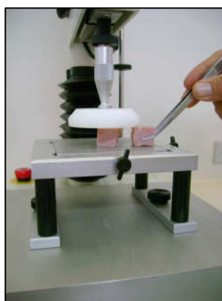
Figura 39 – Medida da Força de Cisalhamento
