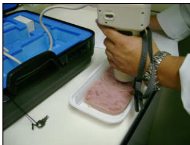
Figura 42 – Avaliação Instrumental da cor
