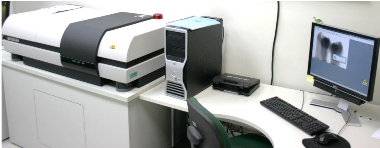
Figura 5 - Scanner \mu CT Skyscan 1172, Bruker-micro CT, Kontich, Bélgica. Onde os espécimes foram avaliados resultando em aproximadamente 650 cortes para cada elemento dentário, que foram reconstituídos pelo software do aparelho e assim foi calculado o volume da coroa e da câmara pulpar de cada elemento.
