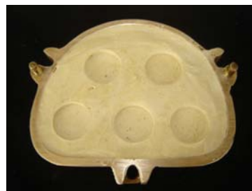
Figura 8 - Orifícios deixados pelos padrões em gesso
