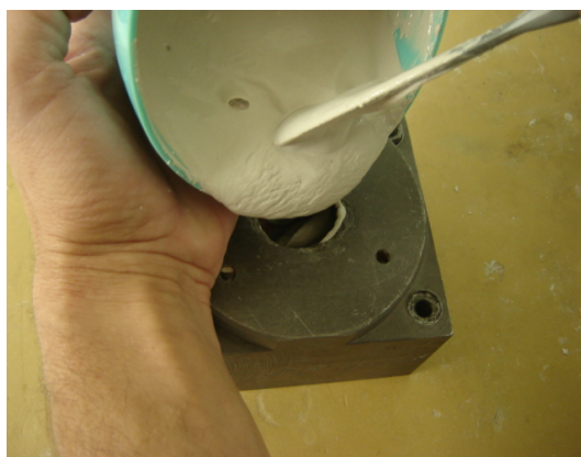
Figura 15 - Vazamento do gesso na porção superior da mufla.
