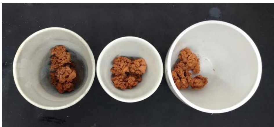
FOTOGRAFIA 8 – Resíduo inorgânico gerado após a queima do lodo obtido no leito de secagem da ETE verde
