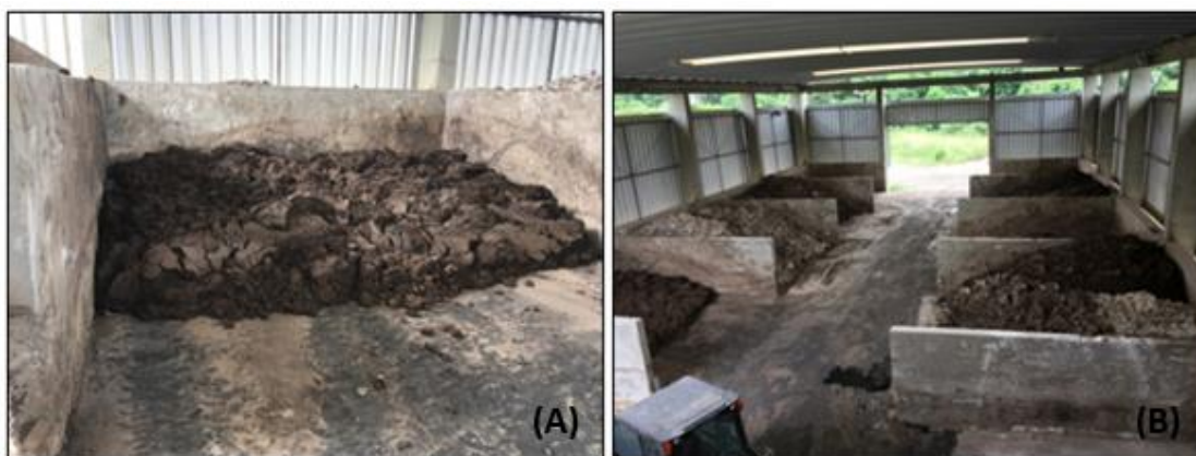
FOTOGRAFIA 7 – (A) Lodo após decanter (já misturado com cal); (B) local de armazenamento de lodo do leito de secagem (já misturado com cal) (ETE Verde, Ponta Grossa-PR)
