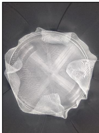
Figura 8. Reator. Fundo (sistema de drenagem).
