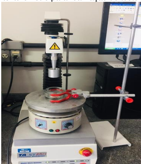
Figura 9 - Teste de mucoadesão. Adaptação do texturômetro para realização do teste.
