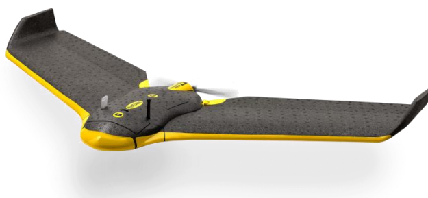
Figura 13 - RPA modelo EBEE usada no imageamento aéreo.
