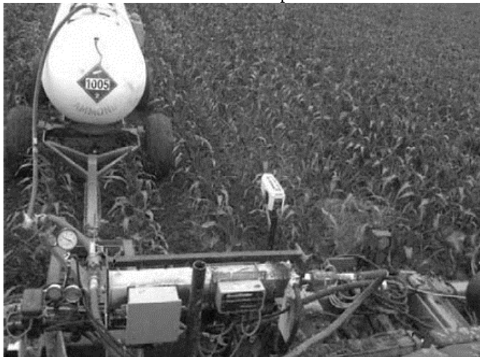
Figura 1 - Sensor ótico GREENSEEKER acoplado a uma semeadora-adubadora.
