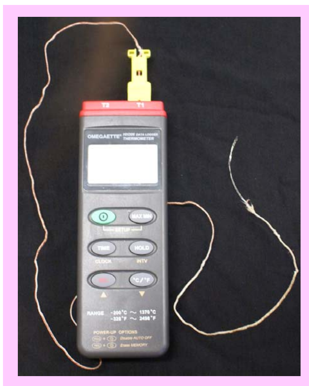
Figura 31- Termômetro digital (OMEGAETTE – HH 306 Data Logger) com o termopar tipo-K conectado.
