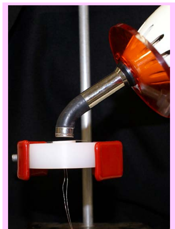
Figura 41 – Remoção do posicionador metálico para a polimerização do incremento de resina composta.
