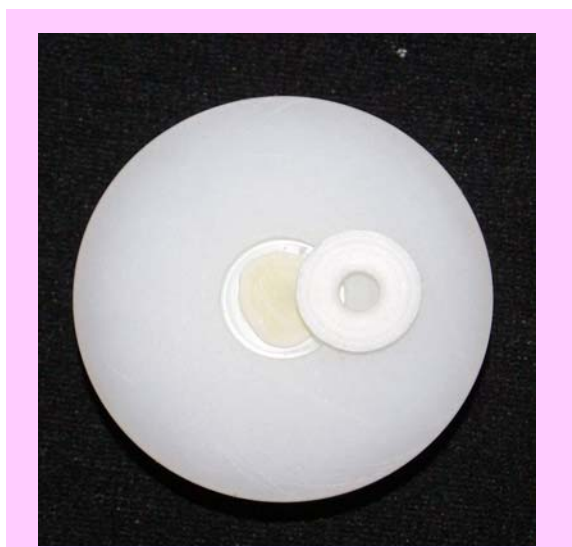
Figura 33 – Base de polímero utilizada para suporte do disco de dentina e para a matriz de nylon.
