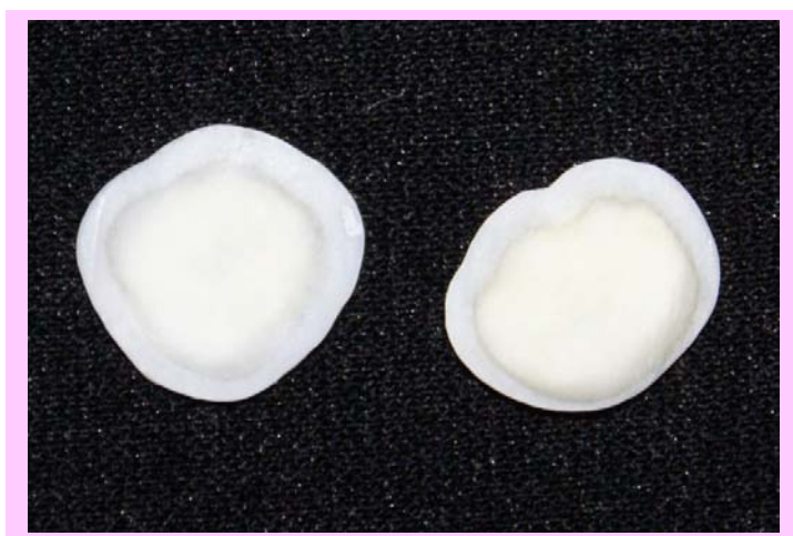
Figura 30 – Discos de dentina obtidos na máquina de corte Isomet 1000 (Buehler).
