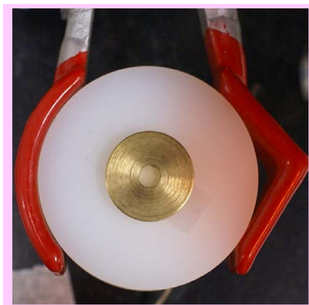
Figura 39 - Posicionador metálico para padronizar a distância da ponta ativa do aparelho fotopolimerizador até o incremento de resina composta.
