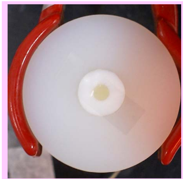
Figura 38 - Resina composta inserida na matriz de nylon com tira de poliéster posicionada sobre a sua superfície.
