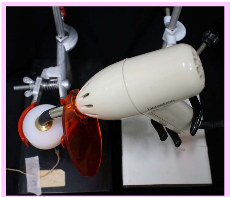
Figura 37 - Posicionador metálico de 2mm de espessura e a ponta ativa do aparelho fotopolimerizador apoiada sobre o posicionador.
