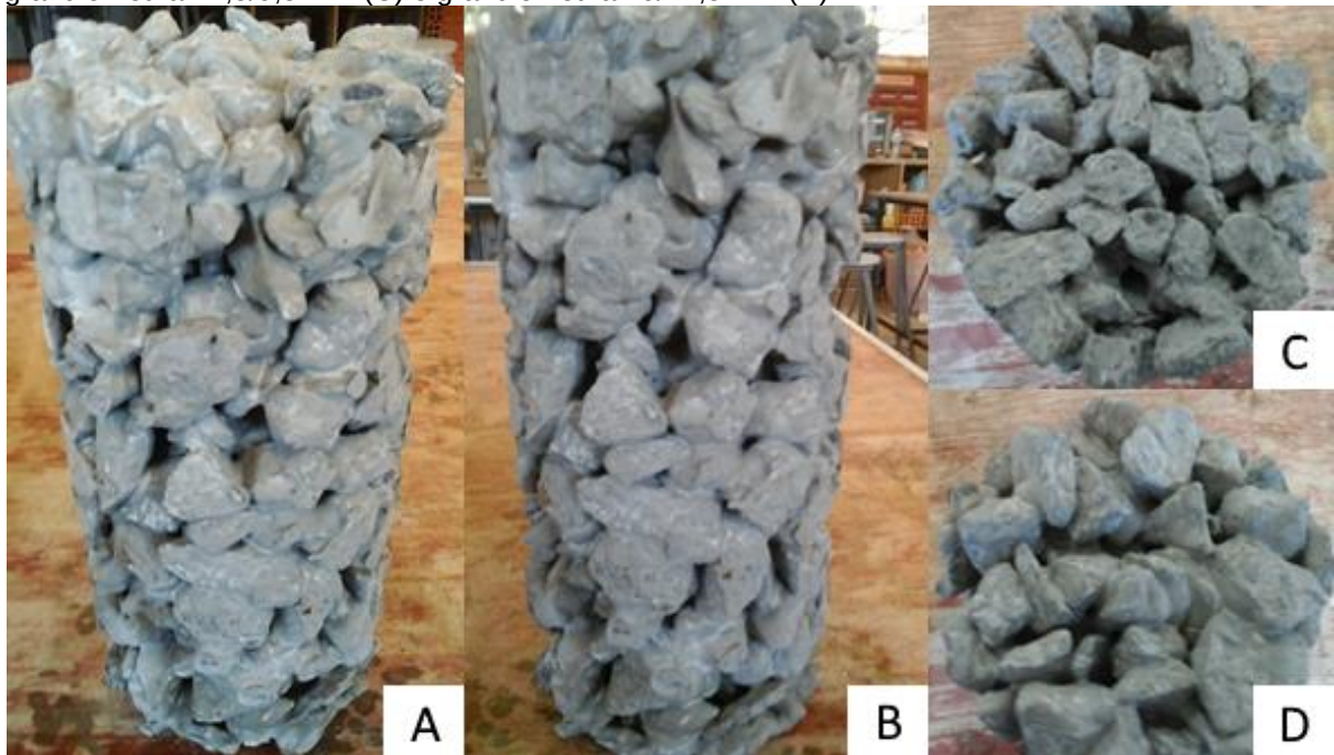
Figura 13 – Fotografia das amostras de concreto permeável confeccionado com agregado na granulometria 12,5/9,5 mm (A) e granulometria 19/12,5 mm (B). Vista superior do corpo de prova da granulometria 12,5/9,5 mm (C) e granulometria 19/12,5 mm (D)
