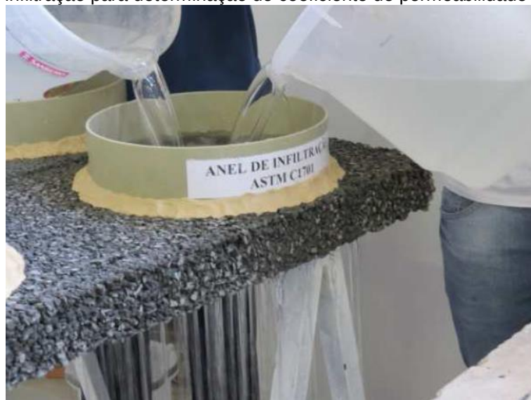
Figura 2 – Anel de infiltração para determinação do coeficiente de permeabilidade
