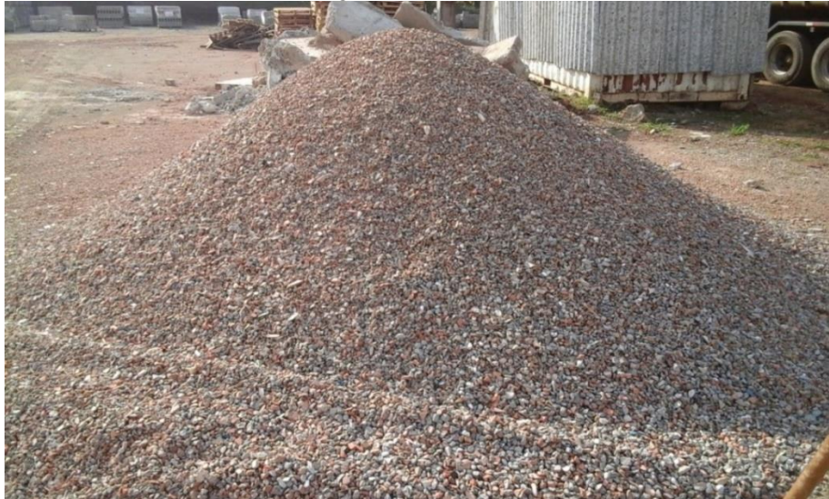
Figura 8 – Agregado reciclado misto, após a trituração de resíduos de construção e demolição contendo concreto e material cerâmico, na granulometria brita 1
