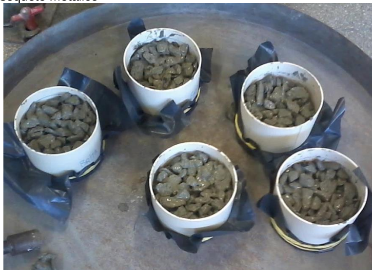
Figura 10 – Moldagem dos corpos de prova cilíndricos em tubos de 10 cm de PVC, com compactação manual utilizando soquete metálico
