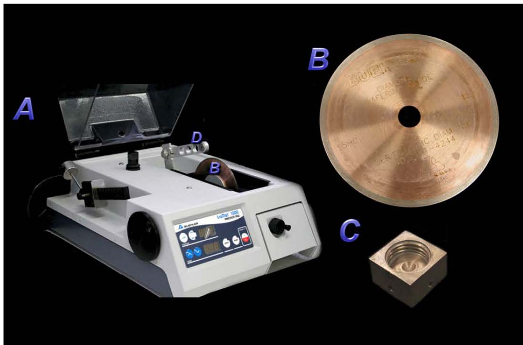
Figura 24 – A – Componentes da Máquina de cortes Isomet 1000; B – Disco de corte; C – Dispositivo para acoplar no braço (D) e D – Braço
