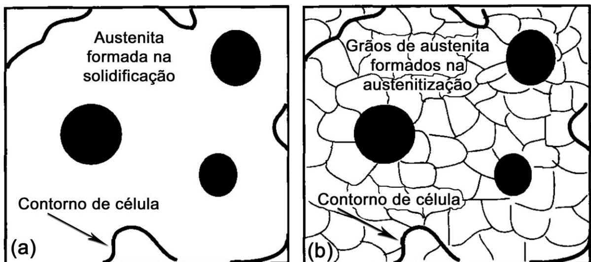
Figura 3.7 – Microestruturas austeníticas esquemáticas de ferros nodulares. (a) Austenita formada durante o processo de solidificação. (b) Grãos de austenita formados durante a austenitização plena.
