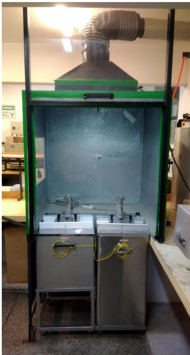
Figura 4.5 – Capela e os fornos de têmpera (à direita) e partição (à esquerda) construídos para o desenvolvimento do trabalho.
