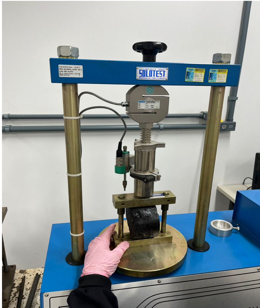
Figura 19 – Ensaio de Resistência à tração por compressão diametral
