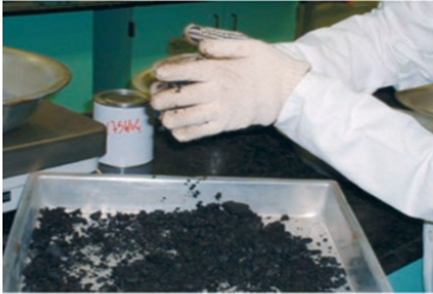
Figura 14 – Preparo da amostra para ensaio Densidade Rice
