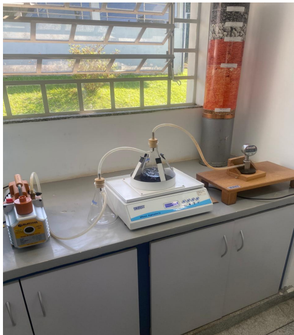
Figura 15 – Conjunto mesa vibratória e bomba
