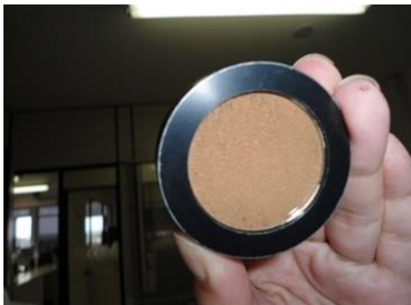
Figura 17 - Foto de uma amostra de solo pronta para ser analisada pelo equipamento Foss.
