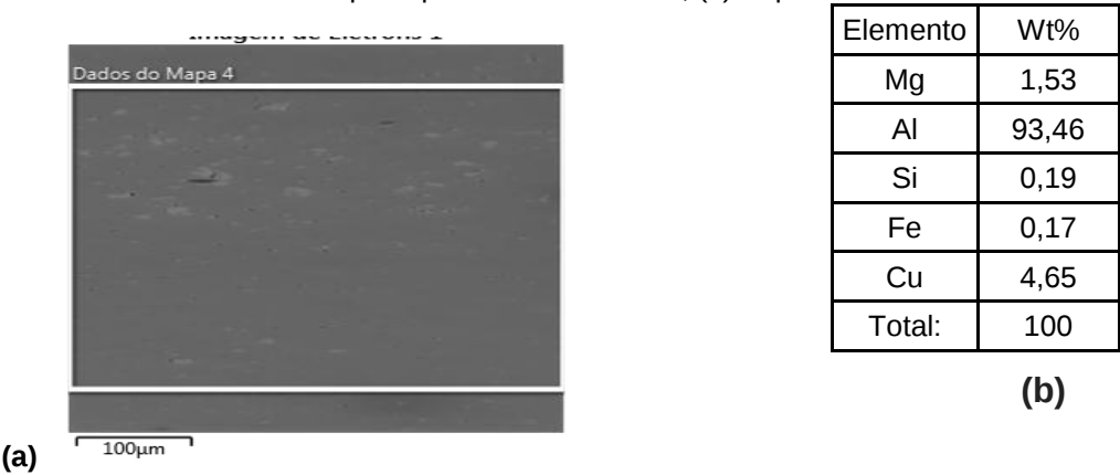
Figura 5. 33 - Microanálise da chapa através de EDS.(a) Imagem analisada; (b) tabela de valores em peso para cada elemento; (c) Espectro.
