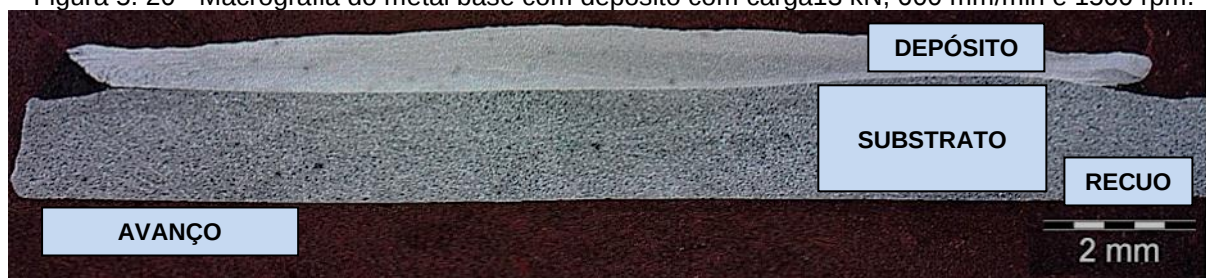
Figura 5. 20 - Macrografia do metal base com depósito com carga 13 kN, 600 mm/min e 1500 rpm.
