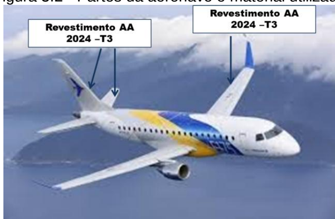
Figura 3.2 - Partes da aeronave e material utilizado.
