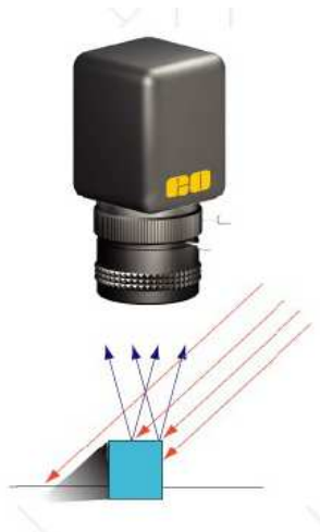
Figura 11 – Iluminação Frontlight direcional
