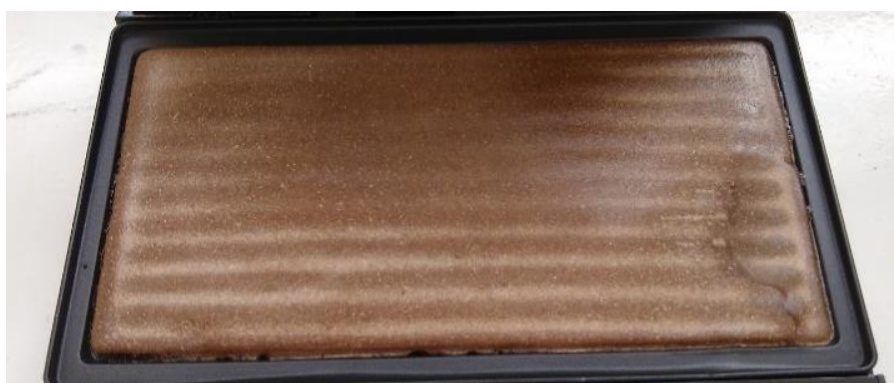
Figura 2.6 – Amido termoplástico prensado em prensa térmica
