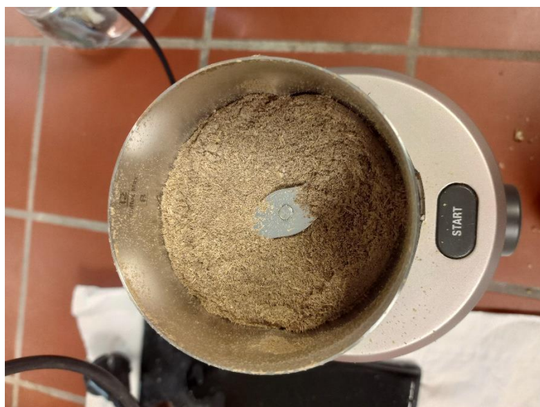
Figura 2.5 – Moedor de grãos apresentando aspecto do bagaço de malte após processo de moagem
