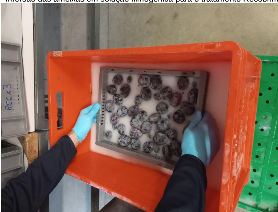
Figura 4.4 – Imersão das ameixas em solução filmogênica para o tratamento Recobrimento
