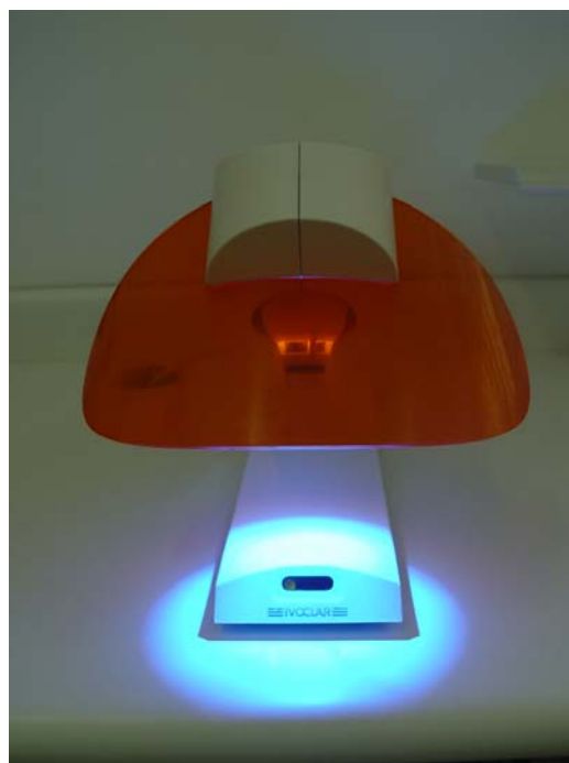
Figura 7 - Unidade Polimerizadora Targis Quick (Ivoclar/Vivadent) onde se realizou a polimerização inicial dos corpos-de-prova do Grupo 2.
