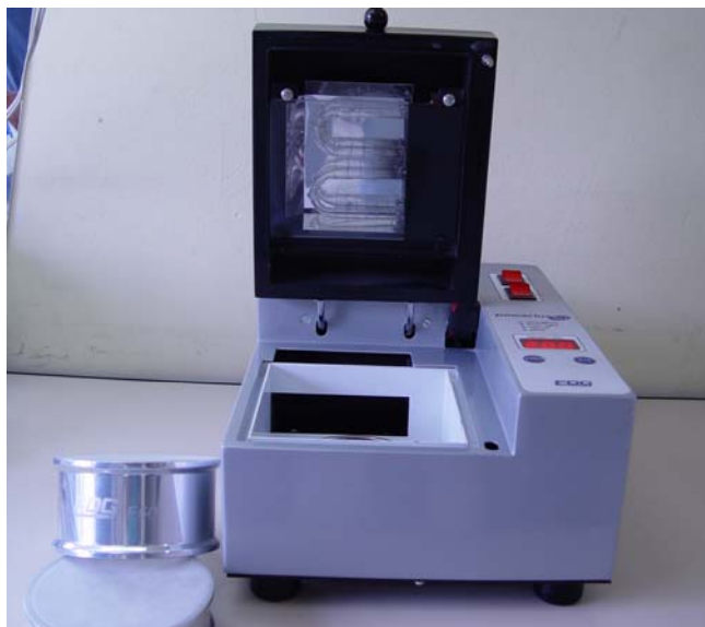
Figura 10- Fotografia da Unidade de Polimerização PowerLux 4x1 (EDG), utilizada na polimerização complementar da Resina Laboratorial Resilab Master (Wilcos), em ciclo de luz por 6 minutos.
