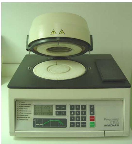
Figura 16- Forno P80 onde se realizou a cocção e o glazeamento dos corpos-de-prova do Grupo 5, confeccionados em porcelana IPS-Empress® 2.
