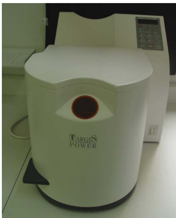
Figura 8 - Unidade Polimerizadora Targis Power (Ivoclar/Vivadent), que utiliza luz e calor, responsável pela polimerização final dos corpos-de-prova do Grupo 2.
