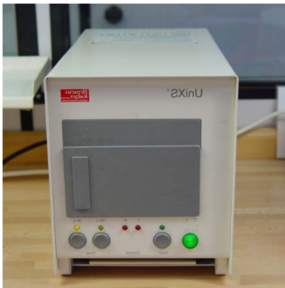
Figura 12 - Unidade de polimerização UniXS (Heraeus- Kulzer), onde se realizou a polimerização inicial dos corpos-de-prova do Grupo 4.
