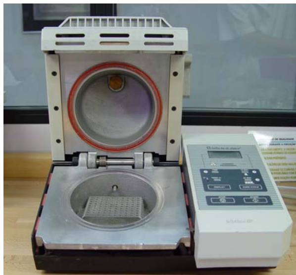
Figura 13 - Curing Unit (Kerr), unidade polimerizadora específica do material restaurador belleGlass HP (Kerr), que combina calor, pressão e presença de nitrogênio.
