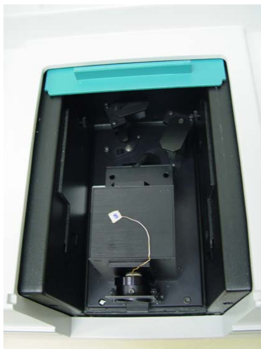
Figura 2 - Fotografia do compartimento de amostra do espectrofotômetro com corpo-de-prova colocado em posição para realização da leitura da cor.
