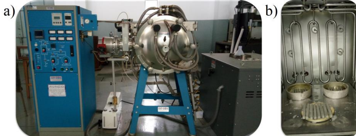
Figura 4.7 – a) Forno da marca OXY-GON INDUSTRIES. b) Detalhe para câmara interna do forno.
