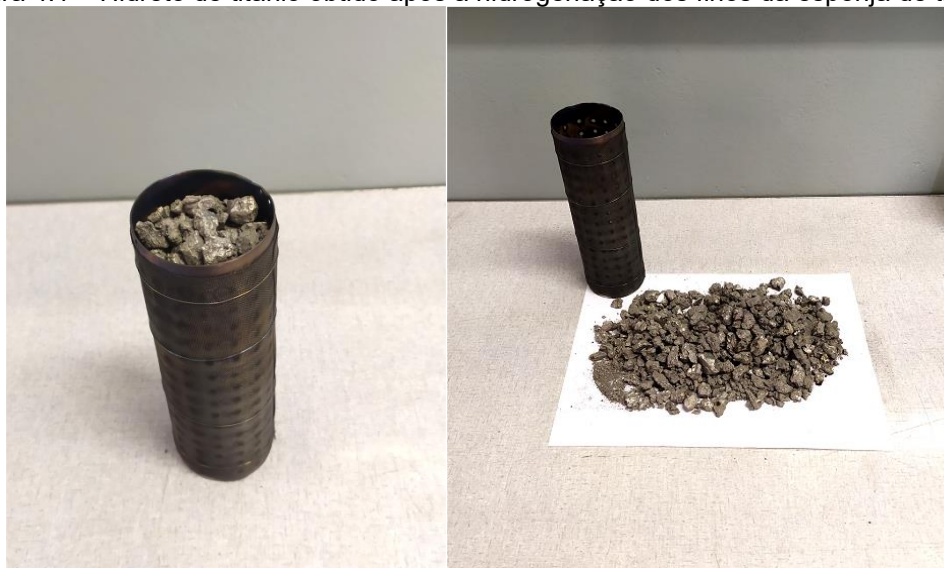
Figura 4.1 – Hidreto de titânio obtido após a hidrogenação dos finos da esponja de titânio.
