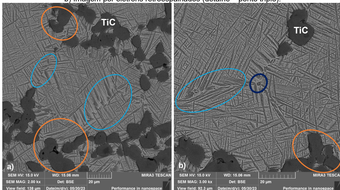
Figura 5.16. Imagens obtidas por microscopia eletrônica de varredura para os compósitos da liga Ti-13Nb-13Zr + 15% de TiC , sinterizados a 1400°C por 1 hora. a) Imagem por elétrons retroespalhados. b) Imagem por elétrons retroespalhados (detalhe – ponto triplo).
