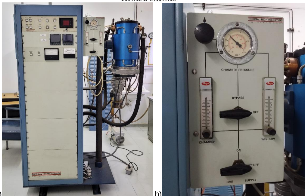
Figura 4.2 – a) Forno da marca Thermal Technology®. b) Detalhe para o controle de pressão da câmara interna.
