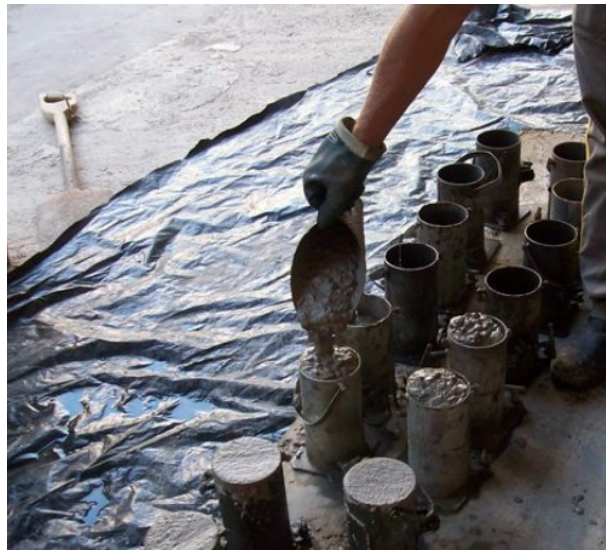
Figura 13 - Moldagem dos corpos de prova
