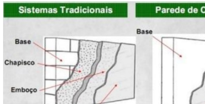
Figura 6-Comparação entre etapas construtivas do acabamento
