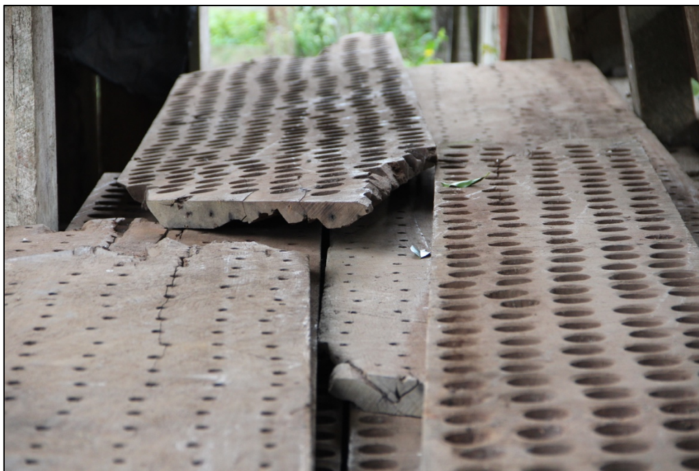
Figura 7: Peneira para separar erva-mate moída. Tábuas em Imbuia. 8
