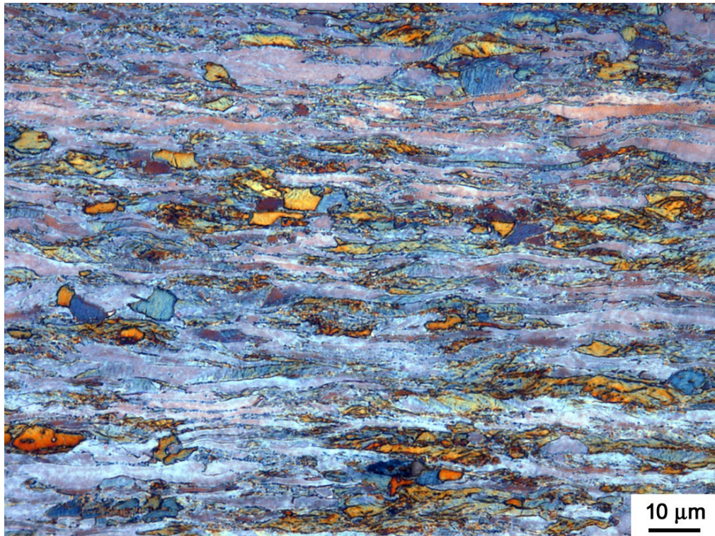
Figura 5.26 - Microestrutura do aço LNE 380 deformado até 70%, tratado termicamente a 700 °C por 60 s (MO). Reagente metalográfico Beraha
