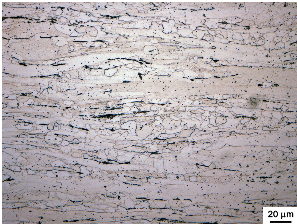
Figura 5.27 - Microestrutura do aço SAE 1006 deformado até 70%, tratado termicamente a 600 °C por 120 s (MO). Reagente metalográfico nital 2% e picral 2% (1:1)
