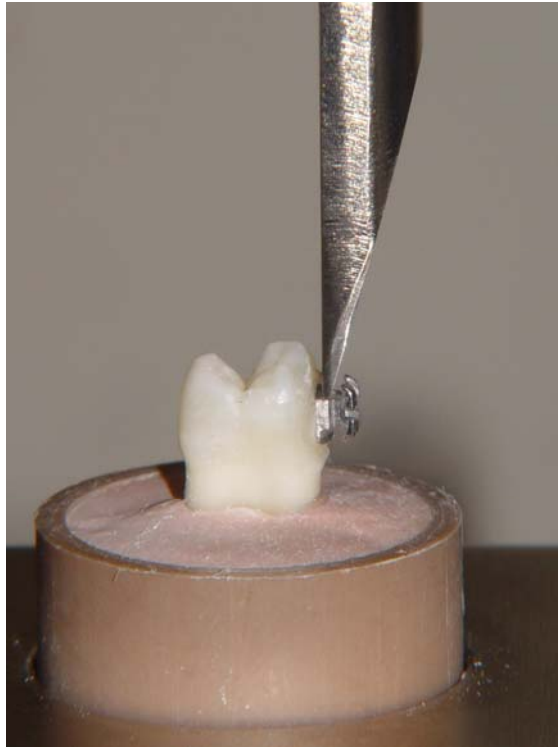
Figura 10 – Incidência do cinzel na interface braquete/dente
