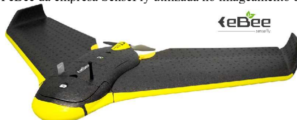
Figura 4 – RPA eBee da empresa SenseFly utilizada no imageamento da área de estudo
